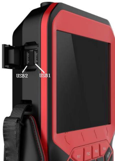
图一定位模块充电接口说明
